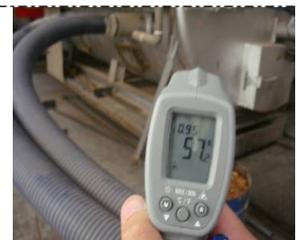
鍋爐爐壁溫度量測
