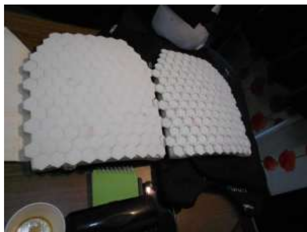
防彈版外層輔以蜂槽結構設計， 可將外來力量迅速引開
